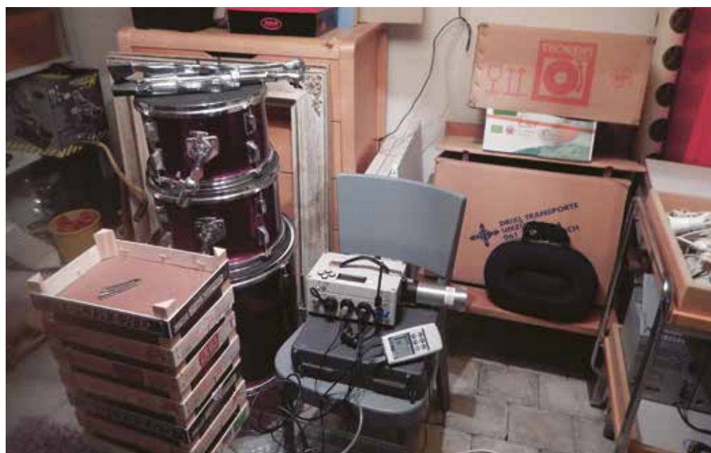
Figure 6.78 : Mesure de radon dans la cave dont le sol n'est pas étanche.
