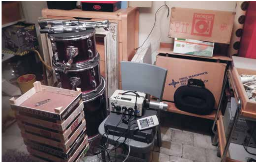
Figura 6.78: Misurazione radon in cantina con pavimentazione non ermetica.
