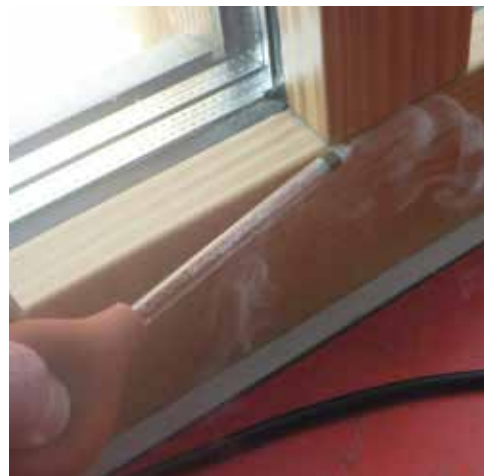
Figura 6.36: Per la verifica dei flussi di aria relativi ai classici punti deboli dell'involucro sono state utilizzate delle macchine per il fumo (InfraBlow.Siegrist GmbH).
