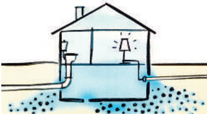
Risse im Beton, Wanddurchführungen von Rohren sind Eintrittsstellen für Radon.
