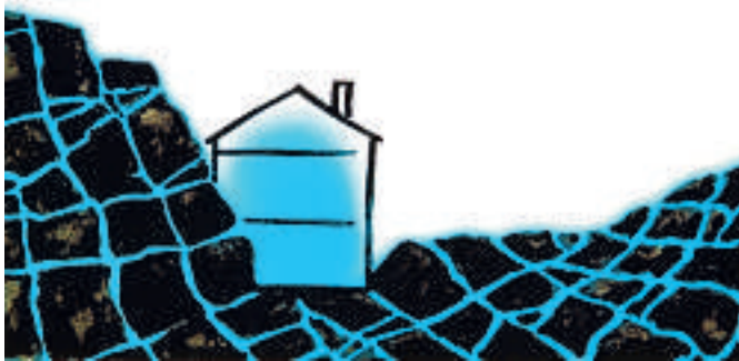
Radon kann über erdberührende Bauteile eintreten.
