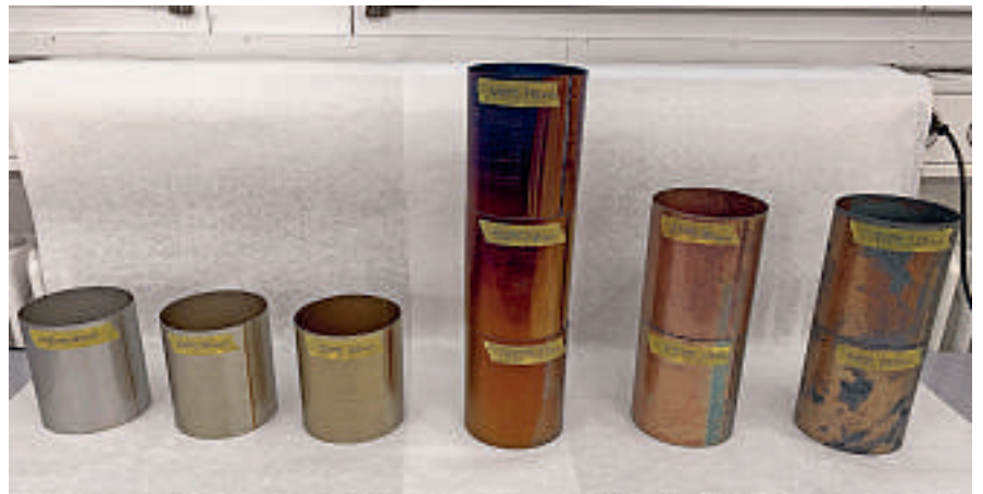
Übersicht der Rohrabschnitte nach den einzelnen Temperaturbehandlungen und Haltezeiten: v.l.n.r.: Lieferzustand, 290 °C, 350 °C, 450 °C, 550 °C und 810 °C
