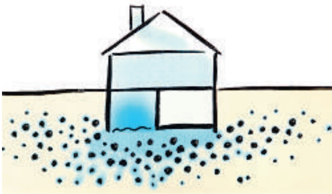
Besonders im Winter steigt Radon im Gebäude auf.
